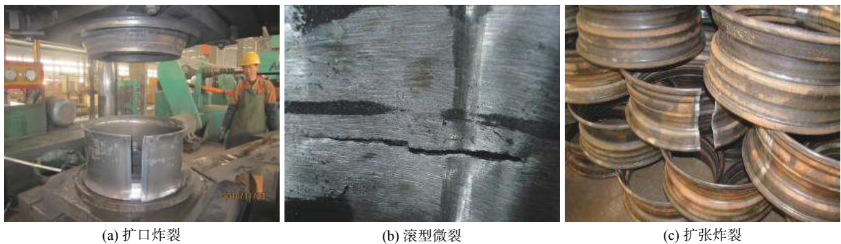
图 1 轮辋闪光焊后焊缝开裂
